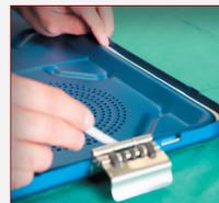
exaktes Einkleben der Silikondichtung in den Containerdeckel
