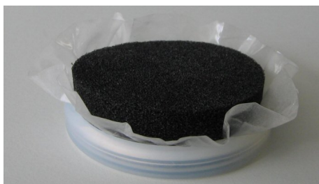
Udskiftning af membran - isætning
