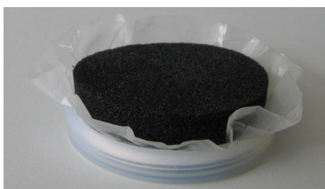
Membranwechsel - Membran einsetzen
