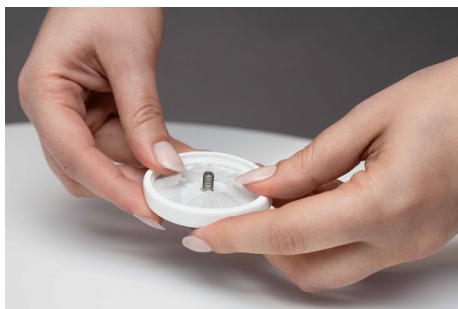
Byta ut membranet – Koppla i oscillatorplattan
