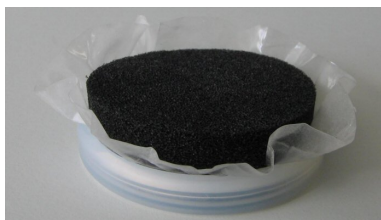
Changement de membrane - Pose de membrane
