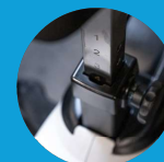
Vertikale Verstellung durch Handgriff mit Rastbolzen
